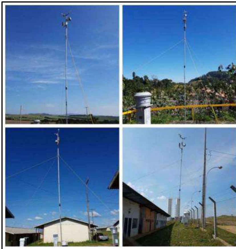
Figura 40 – Estação meteorológica da LENTZ instalada nos quatro pontos de monitoramento.
