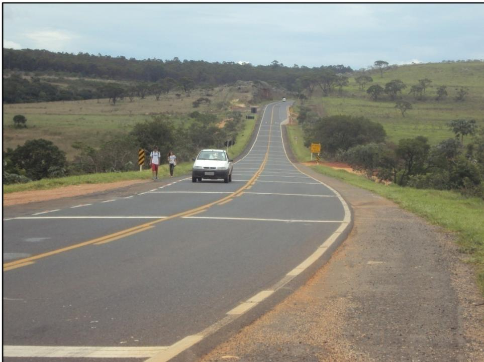
**Figura 3.2-2:** Exemplo de sinalização de advertência em trecho da rodovia próximo travessia de drenagem. Deve ser adotado também para os locais onde ocorrem travessias de drenagens com captação a jusante.
