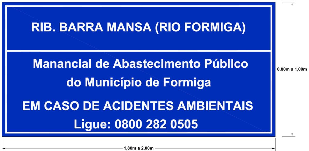
**Figura 3.1-2:** Modelo de placa de sinalização a ser implantada junto a travessia do Ribeirão Barra Mansa (Confluente do Rio Formiga), km 196+010 da MG-050, município de Formiga.
