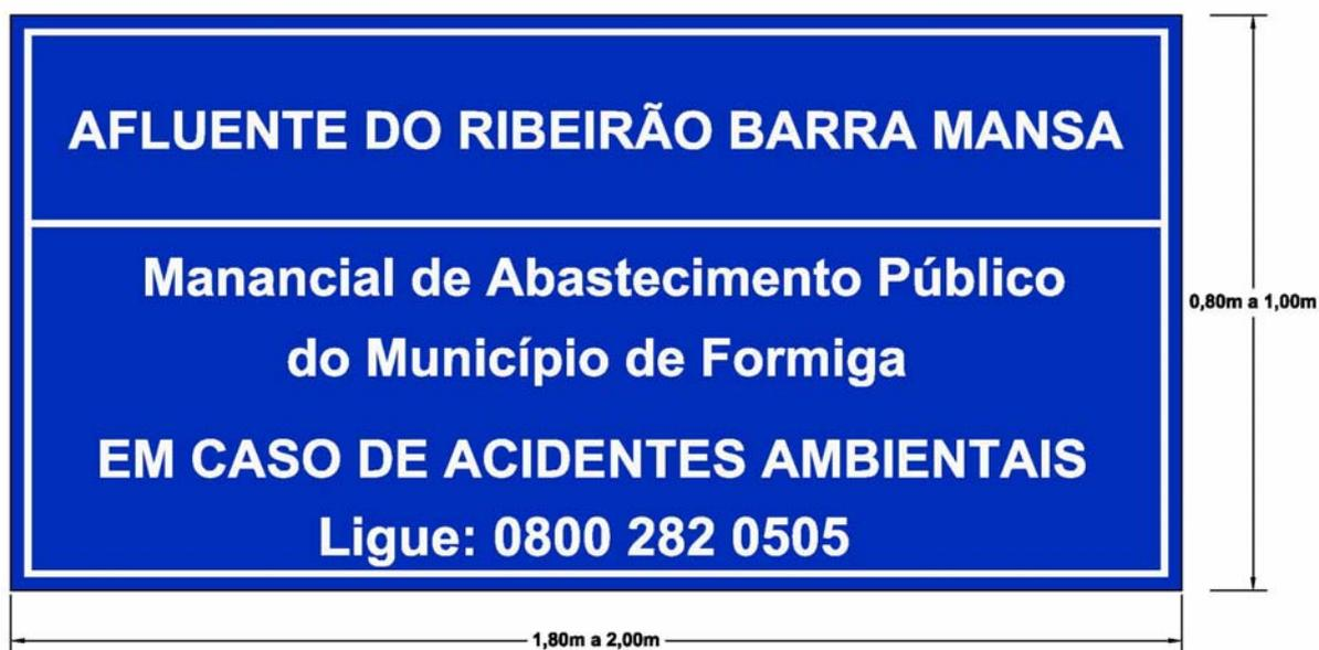
**Figura 3.1-1:** Modelo de placa de sinalização a ser implantada junto a travessia do Afluente do Ribeirão Barra Mansa, km 193+700 e km 195+300 da MG-050, município de Formiga.
