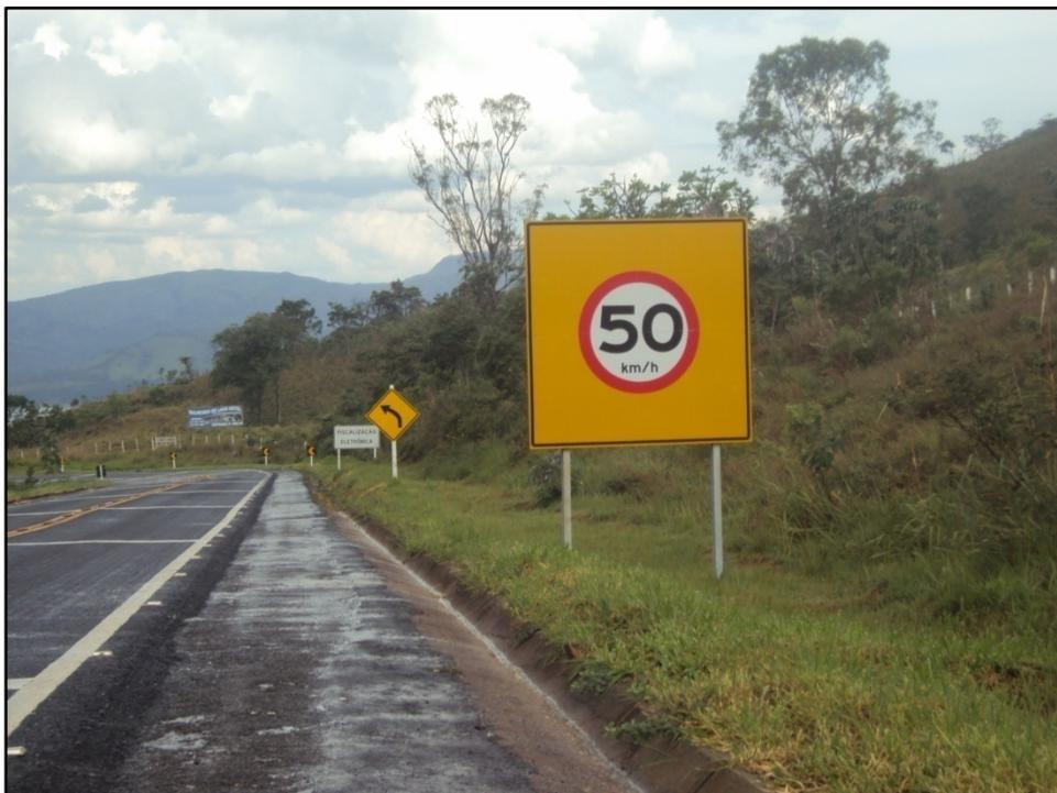
**Figura 3.2-4:** Exemplo de sinalização de estímulo a redução de velocidade. Deve ser adotado também nos trechos onde ocorrem travessias de drenagens com captação a jusante.
