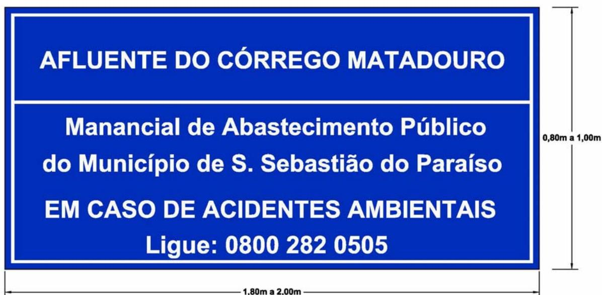
**Figura 3.1-8:** Modelo de placa de sinalização a ser implantada junto aos afluentes do Córrego Matadouro, km 3+300 da BR-491 e km 638+100 da BR-265, ambos no município de São Sebastião do Paraíso.
