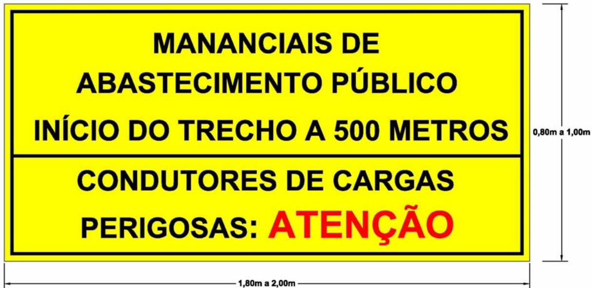
**Figura 3.1-10:** Modelo de placa de sinalização a ser implantada 500 metros antes do início dos trechos (em ambos os sentidos) de mananciais para abastecimento público.
