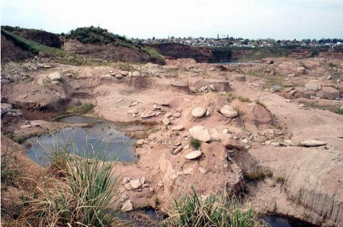
**Figura 1-30: Cantera que explota el manto de alteración del granito de La Paz en la zona estudiada**
