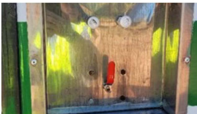
Exemplo de equipamento de emergência: lava-olhos, instalado no veículo destinado ao uso dos trabalhadores da equipe de aplicação manual de agroquímicos.
