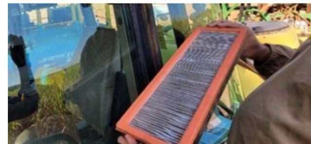
Filtro de carbón activo responsable de la calidad del aire en la cabina del pulverizador autopropulsado.
