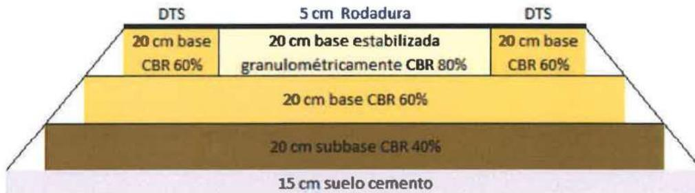
**Figura 4-29** Sección del pavimento
